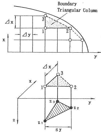
図-4 末端部の三角柱体
