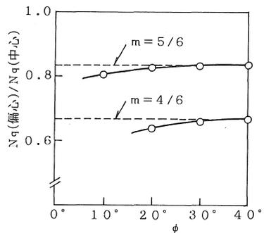
図-5 偏心載荷時の N<sub>q</sub>
