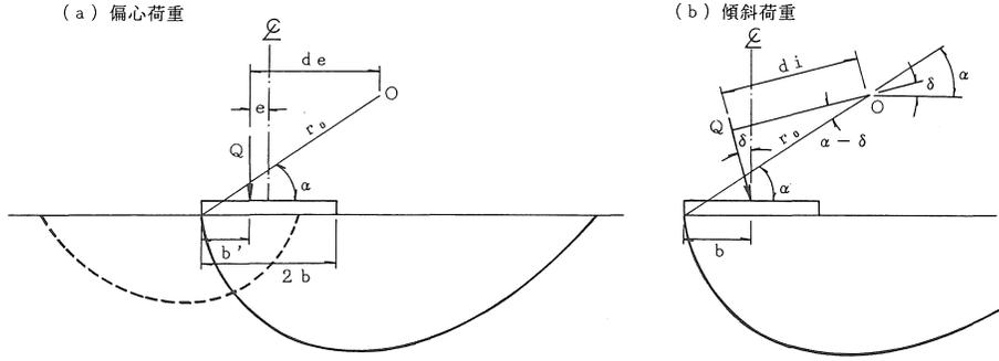
図-3 偏心および傾斜荷重
