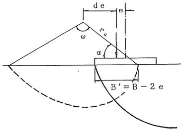
図-6 偏心載荷時のすべり線
