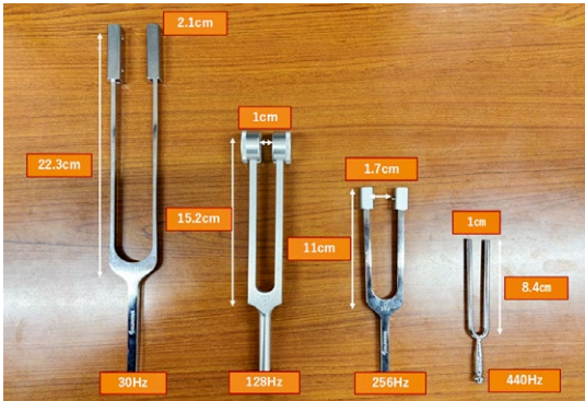
図－2 音源として使用した音叉
