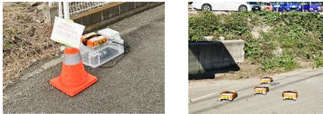
写真1 (左) 中アレイの観測の様子 (センサー：VSE、ロガー：JU410)、(右) 小アレイの観測の様子
