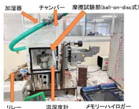
図 1：温湿度調整機構付き摩擦試験機の外観
