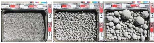
図-4 生成された再生球状骨材 (室内試験試料)
