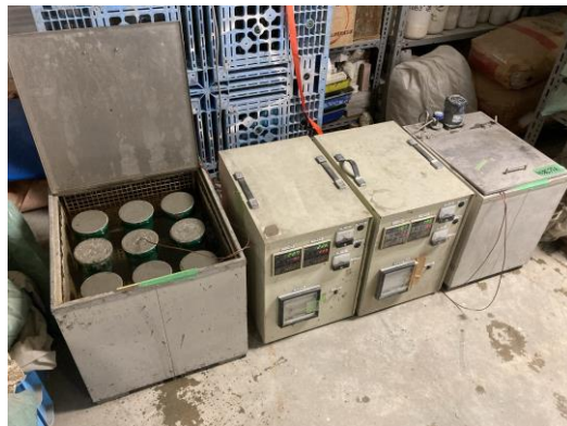
図-5.7 円柱供試体の温度追随養生
