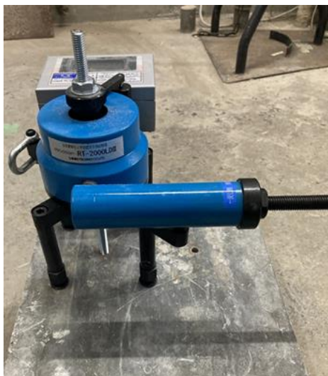
写真-6.1 引き抜き試験
