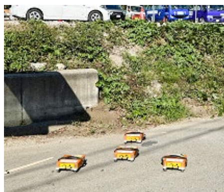
写真1 (左) 中アレイの観測の様子 (センサー：VSE、ロガー：JU410)、(右) 小アレイの観測の様子
