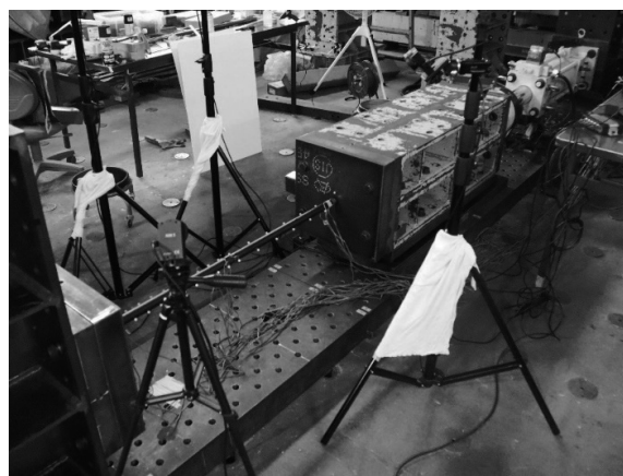
写真1 座屈実験の実施状況
