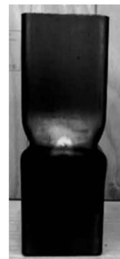
写真-1 木材挿入鋼管の最終破壊状況
