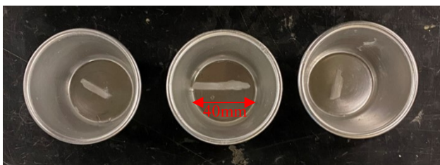
写真 2 粉状化観察用のローモンタイトの単結晶
