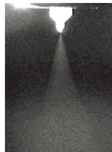
図 3 エレクトロスプレーの様子 (9kV, 0.1mL/h)
