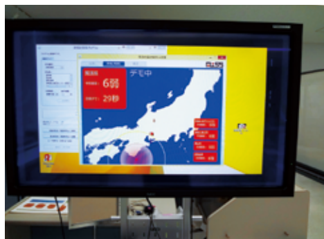
写真2 緊急地震速報用モニター
