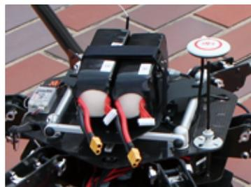
図2 GPS信号受信アンテナ
