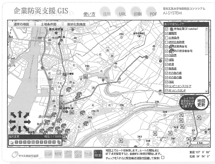
図8 緊急輸送道路を回避したルート検索結果画面 (画面中央の道路(緑色)が緊急輸送道路)
