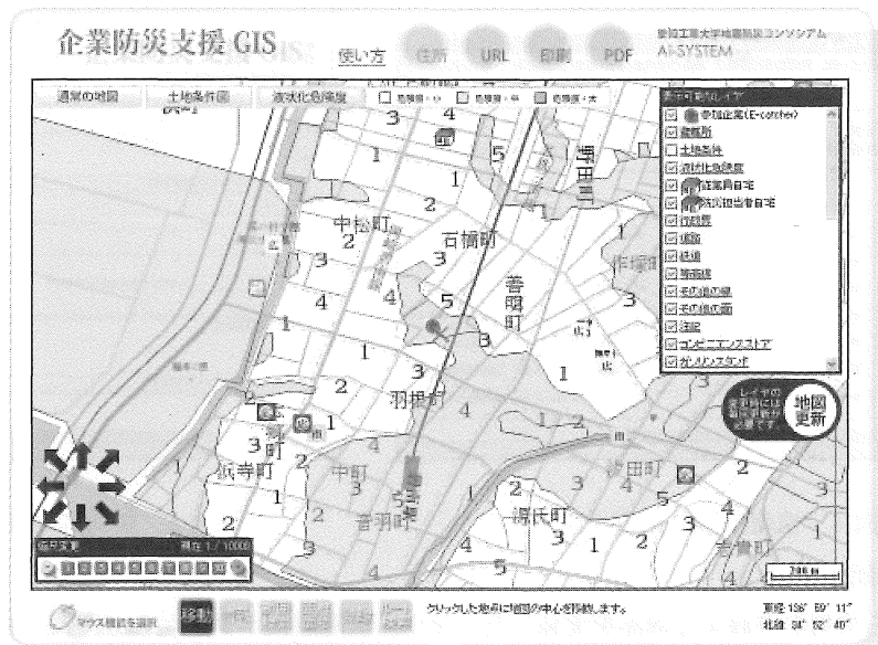
図2 災害ハザードデータ表示の例（液状化危険度）
