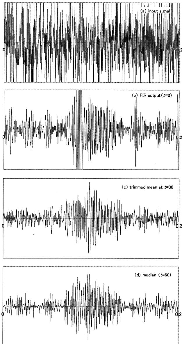
図5  $\alpha=1.4$  の安定分布に従う雑音を加えた Sweep 信号と出力応答
