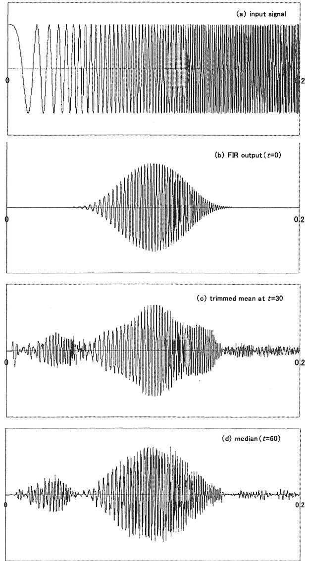
図 3 雑音のない Sweep 信号と出力信号
