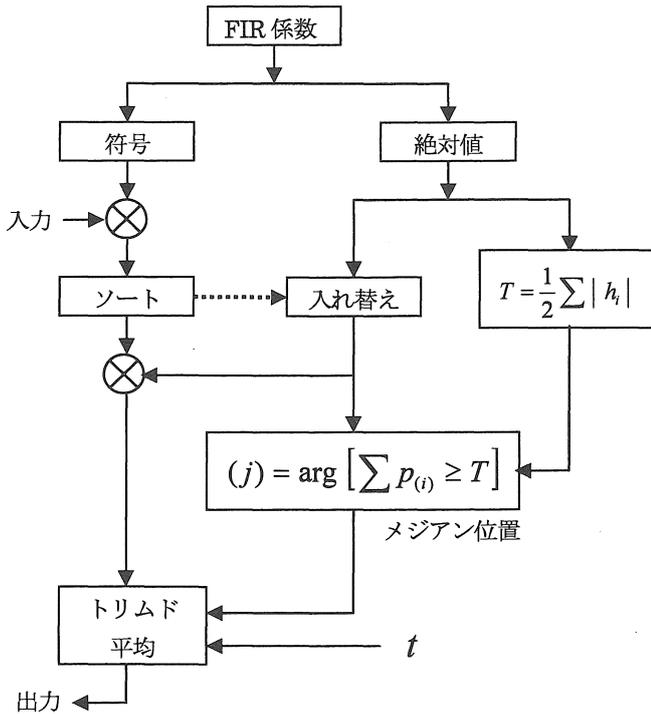
図 2 トリムド平均フィルタのフロー図
