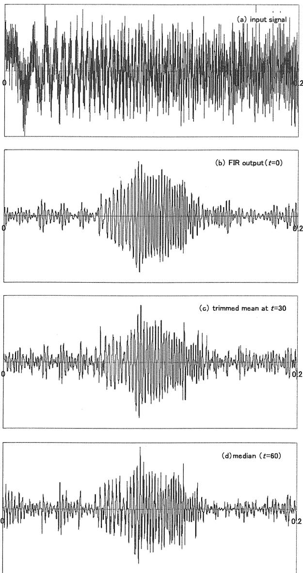
図4 ガウス雑音を加えた Sweep 信号と出力信号
